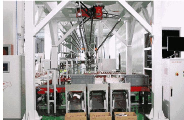
SHUTTLE货架穿梭车：在货架间飞速移动货物，速度快到6m/s，每小时可以处理1600箱！
