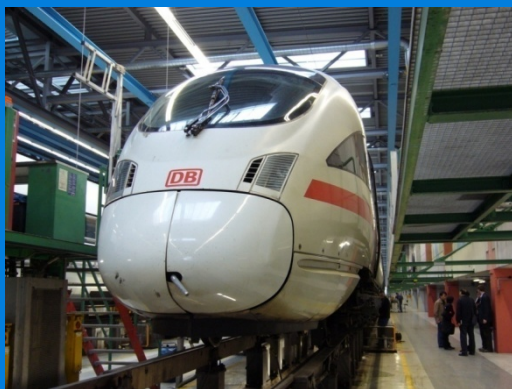
动车组检修 EMU overhaul
